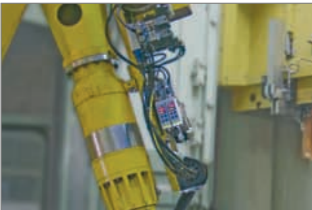
Zentrale Vakuum-Erzeugung durch Kompaktejektoren SXPi / SXMPi
