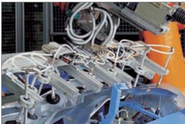
Zentrale Vakuum-Erzeugung durch Kompaktejektoren SCP bei der Handhabung von Karosserieteilen
