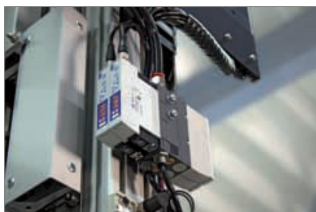
Zentrale Vakuum-Erzeugung durch die Kompaktejektoren SMPi
