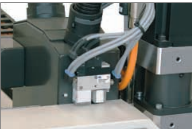
Zentrale Vakuum-Erzeugung durch Kompaktejektoren SCPM
