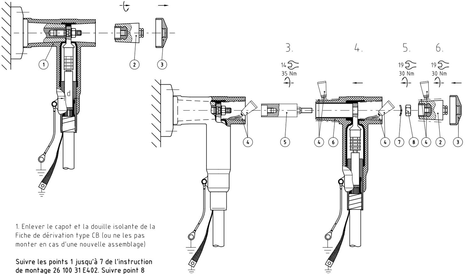
1. Enlever le capot et la douille isolante de la Fiche de dérivation type CB (ou ne les pas monter en cas d'une nouvelle assemblage)
