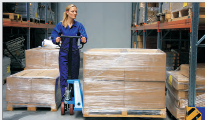
Der BF-TD ist 4-Wege tauglich und kann so vorwärts, rückwärts und seitwärts rangieren. So ist er auch in engen Lagern und zugestellten Gängen nutzbar.
