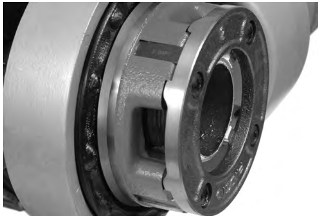
Figura 15 – El extremo del tubo está al ras con el borde de las terrajas
