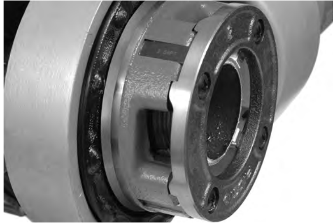
Figure 15 – Tuyau arrivé à fleur des filières
