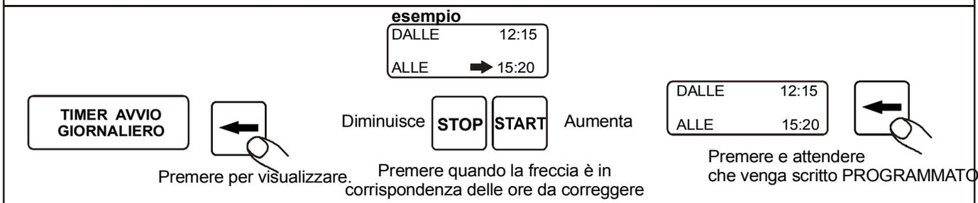
**ARRESTO.** Blocca l'avviamento o il moto del motore.
