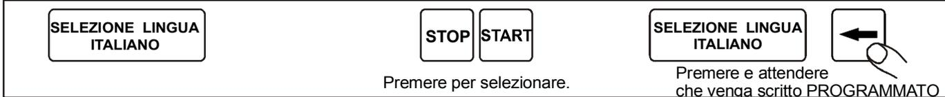
**PROVA AUTOMATICA SETTIMANALE.** Terminata la programmazione **PROVA AUTOMATICA SETTIMANALE INCLUSO**, con centralina in automatico, il gruppo motore esegue il ciclo di prova.
