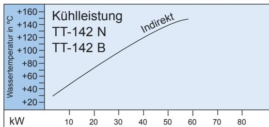
Beim Modell **TT-142** erfolgt die Kühlung über den gesamten Temperaturbereich durch den Wärmetauscher (indirekt).
