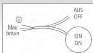
Schwimmschalter PSN-F zum Vollpumpen
