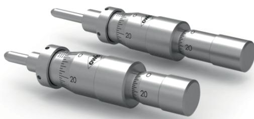
Die OWIS® Differential-Messschrauben MSD haben gehärtete und präzise geschliffene Spindeln. Die Skalenwerte von 0,5 µm gestatten kleinste Positionsänderungen. Messtrommel und Messhülse sind matt verchromt und bieten daher größtmöglichen Kontrast zu den Skalenstrichen. Als Druckstück ist eine gehärtete Stahlkugel in die Spindel eingelassen. Damit eignen sich diese Messschrauben vor allem als hochpräzise Stellantriebe.
